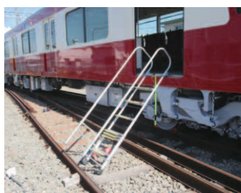
▲非常脱出ハシゴを設置した様子
