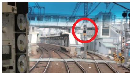
▲神奈川新町第1踏切道(下り線)に対する発光信号機の増設等
